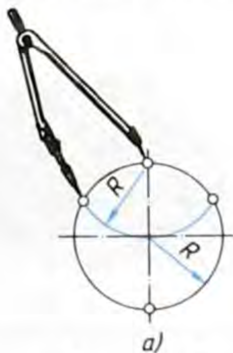
126-сүр. Айлананы барабар үч бөлүккө бөлүү: а – циркулдун жардамы менен; б, в – бурчтуктун жана сызгычтын жардамы менен
