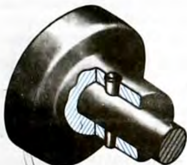
228-сүр. Штифт менен бириктирүүнүн айкын сүрөттөлүшү
